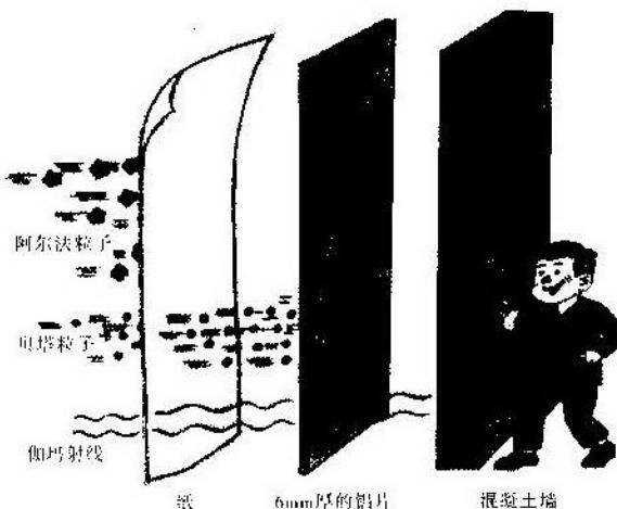
图 6.1  $\beta$  射线的防护示意图
